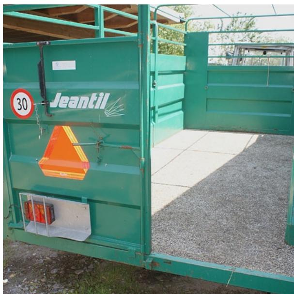
*Aucune rampe n'est nécessaire grâce à la remorque abaissable hydrauliquement.*
