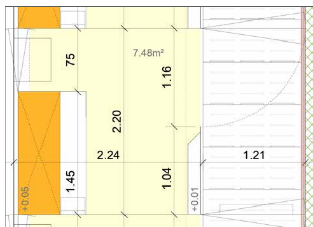
Plan Krieger SA Orange: Nid à porcelets, jaune: gisoir de la truie, blanc: aire de déjections.
