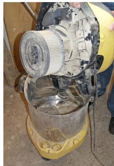
*Un aspirateur muni d'un filtre sert au nettoyage.*
